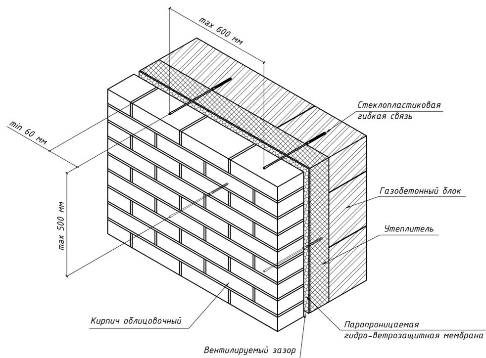
Узел крепления облицовки фасада из кирпича к стене из газобетонных блоков.
