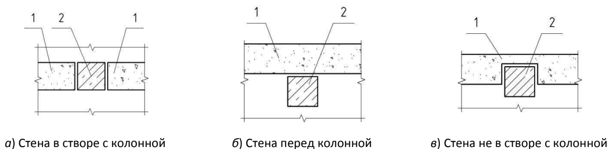
Рис. 4.6. Схемы расположения стен по отношению к вертикальным конструкциям несущего каркаса здания 1 - стена; 2 - колонна
